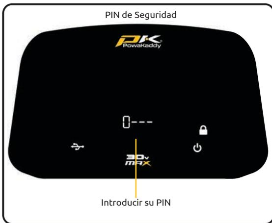
**PIN Seguridad:** Con el icono del candado resaltado, puede activar y desactivar la función PIN presionando el botón central. Para seleccionar su PIN de seguridad, gire el botón central para seleccionar su código de 4 dígitos, guarde cada dígito presionando el botón central. Repita para cada dígito y luego presione y mantenga presionados ambos botones para guardar el nuevo PIN.
