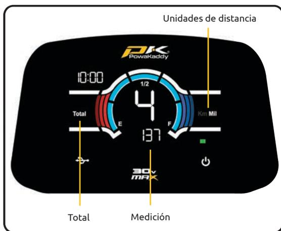
**Botón de función derecho -** Presione para alternar entre yardas/ metros (millas/kilómetros).
