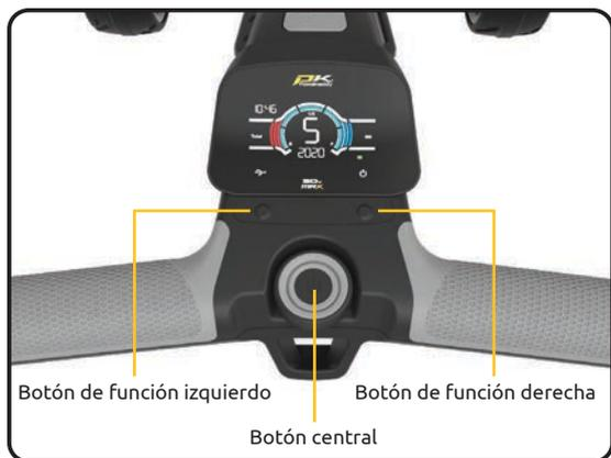
Una vez que la batería esté completamente cargada y conectada, su carro estará listo para usar. Las funciones de control se detallan a continuación.
